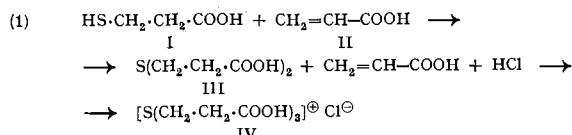
Dieses Sulfoniumsalz ist aus absolutem Alkohol umkristallisierbar, leicht in Wasser löslich, aber unlöslich in den üblichen organischen Lösungsmitteln. Sein Fp liegt bei 163° (Zers.). Die Carboxyl-Gruppen lassen sich alkalimetrisch (Phenolphthalein), das Cl-Ion nach Volhard titrieren.
